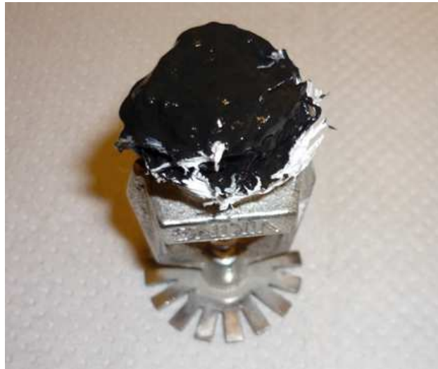
Figuur 3: - slijm of zwarte modder door bacteriën. (bron: MIC Europe BV)
